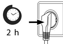
Permita que o eletrodoméstico funcione vazio por 24 horas para que o compartimento possa resfriar até a temperatura apropriada.
